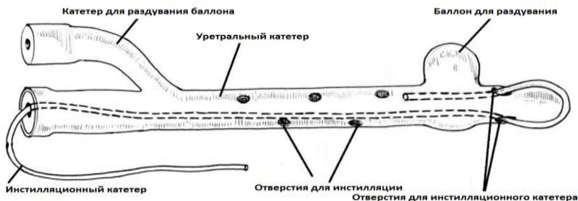
Рис. 2.4.12. Схематическое строение уретрального катетера
